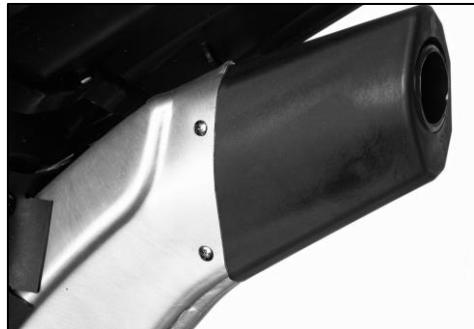
El silenciador del tubo de escape incorpora una parte final desmontable fijada por solo tres tornillos. Permite la manipulación y el cambio de fibras del silenciador.
