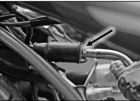
El cable del gas nunca debe estar en tensión. La tolerancia del cable del gas viene regulada de fábrica, pero el usuario también puede graduarlo con el tensor a rosca que une la funda del cable con el carburador.
