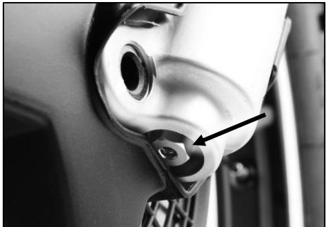
Para vaciar el aceite de la suspensión delantera debe aflojarse completamente el tornillo de la parte inferior de la botella. Debe tenerse en cuenta que el mismo tornillo sujetá el anclaje de la barra. El llenado se realiza quitando el tapón superior de cada barra.
