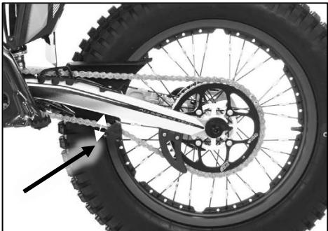
Es recomendable revisar periódicamente la tensión de la cadena. Con la moto en reposo, el oscilamiento de la misma en la zona donde actúa el patín del tensor debe ser de entre 3 y 4 cms. La cadena debe ser objeto de una atención especial ya que su buen mantenimiento depende la vida útil del conjunto piñon, corona y de la propia cadena. Es recomendable su limpieza y engrase con frecuencia. Usar grasa Minerva especial de cadena.
