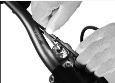
La regulación de la precarga de muelle se realiza solo en la barra izquierda. Con esta regulación se establece la dureza con la que queremos trabaje la suspensión.
