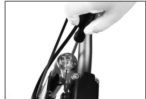
En la barra derecha se regula el hidráulico. Con esta regulación se ajusta directamente la rapidez de funcionamiento sobretodo en capacidad de absorción y retorno.
