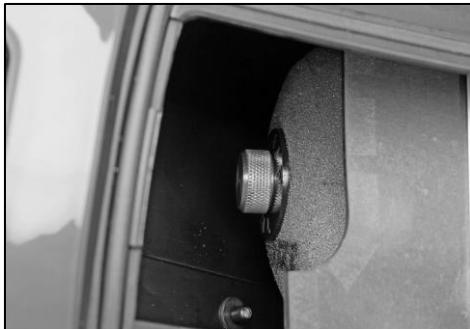
Es muy importante realizar operaciones periódicas de limpieza del filtro de aire, sobretodo cuando el uso de la moto se realiza en entornos polvoríentos. Antes del montaje es importante aplicar aceite Minerva especial para filtros.
