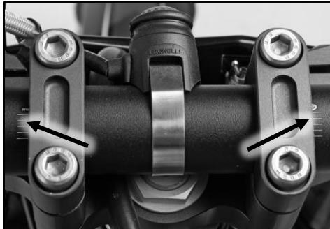
Para ajustar la correcta posición del manillar, dependiendo de la altura del conductor, el manillar incorpora marcas para facilitar, tanto el centrado como su posicionamiento y distancia respecto al puesto de conducción.
