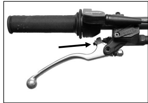
El margen de tolerancia para el accionamiento del bombín del freno delantero puede ser regulado a la medida y según el usuario.
