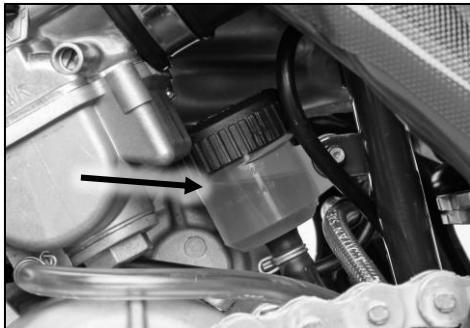
Verificar el nivel del líquido DOT 4 Minerva del freno trasero. El depósito es fácilmente visible desde el lado izquierdo de la moto, justo detrás del carburador.
