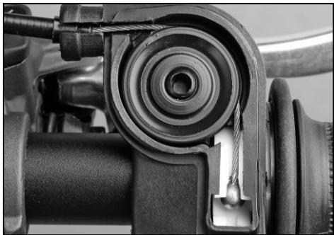
Para mantener el funcionamiento del gas de forma eficiente es necesario mantener el puño del gas limpio y engrasado, así como el punto donde va anclado. Es importante verificar que el cable del gas no está forzado en ningún punto desde el manillar hasta el carburador.
