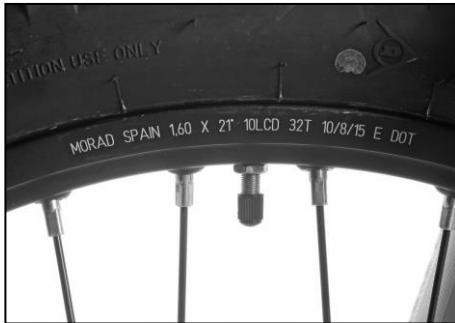
Para uso standard la presión de hinchado del neumático delantero debe ser de entre 0,38 y 0,40 bar. Para el neumático trasero -tubeless- la presión de hinchado debe ser de entre 0,27 y 0,30 bar. Para recorridos en excursiones largas, es recomendable utilizar la mayor presión posible recomendada.
