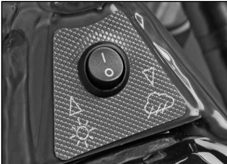
Con el control electrónico de funcionamiento del motor a través del CDI, este puede ser regulado en dos posiciones para regular la respuesta del motor en condiciones climáticas óptimas o en situaciones más difíciles.
