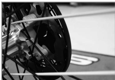
Der Verschleiß der Scheibenstärke tritt im Kontaktbereich zwischen Bremsscheibe und Bremsbelägen auf.
