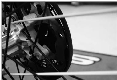
El desgaste del grosor de los discos se produce en la zona de contacto entre el disco y las pastillas de freno.
