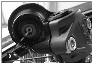
El ajuste de la amortiguación en compresión influye en el comportamiento de la horquilla en el momento del hundimiento.
