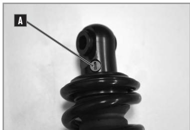
Die Einstellung der Zugstufe des Stoßdämpfers erfolgt mithilfe der Stellschraube **A** oben am Stoßdämpfer.
