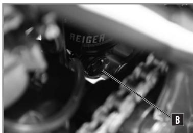
Le réglage en compression de l'amortisseur s'effectue à l'aide de la molette de réglage B située au niveau du pied d'amortisseur.
