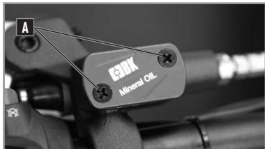
Le réservoir du liquide d'embrayage est situé au dessus de la manette.
