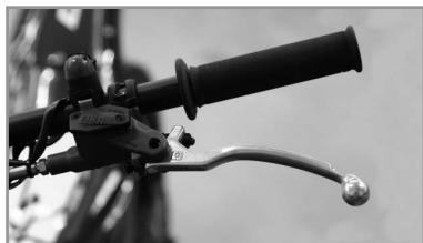
Der Kupplungshebel befindet sich am linken Griff des Lenkers.
