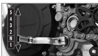
Der Fußschalthebel 1 befindet sich vor der linken Fußraste.
