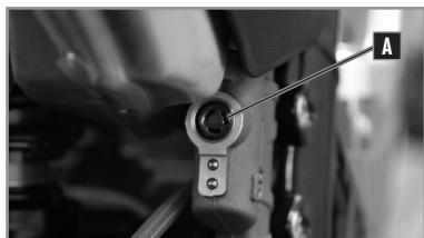
Der Bremsflüssigkeitsbehälter befindet sich direkt am Hauptbremszylinder.
