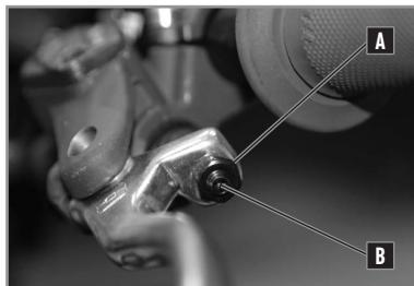
Die Spannung des Kupplungshebels wird mithilfe der Gewindestange **B** eingestellt.
