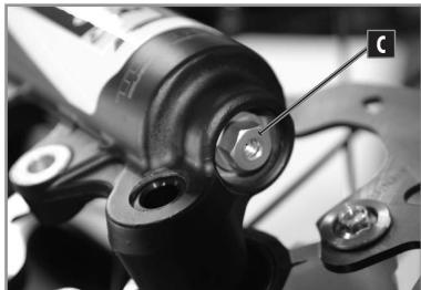
Der Hydrostop-Ring bestimmt das Verhalten der Endlagendämpfung und die Durchschlagfestigkeit der Gabel.
