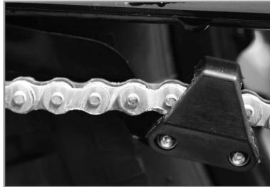
Der Kettenspanner gehört zu den am stärksten beanspruchten Elementen, insbesondere die Feder, die dafür zuständig ist, den Druck auf die Kette aufrechtzuerhalten.
