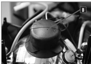
Type d'ampoule: 12 V 35/35 W
