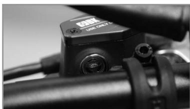
Le réservoir du liquide de frein avant est situé à côté de la manette. Il est doté d'un petit regard qui permet de contrôler le niveau du liquide.
