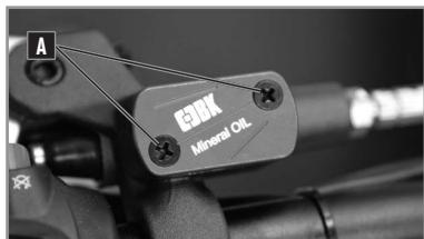
Der Kupplungsflüssigkeitsbehälter befindet sich unter dem Hebel.
