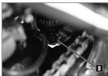
El ajuste de la compresión del amortiguador se realiza con la ruedecilla situada al nivel de la base del amortiguador.
