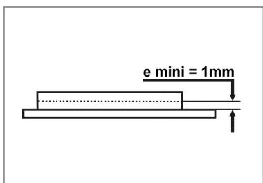
El desgaste del grosor de las pastillas se produce en la zona de contacto entre el disco y las pastillas de freno.
