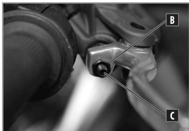
Pour permettre une bonne pression sur la manette lors du freinage, il est nécessaire que sa position soit adaptée à la mesure du conducteur.
