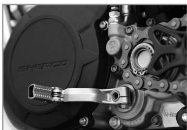
Das Schaltgetriebe besteht aus fünf Gängen plus Leerlauf oder Neutralstellung.
