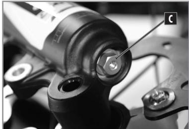
La bague Hydrostop détermine le comportement de l'amortissement de fin de course et la résistance aux impacts de la fourche.
