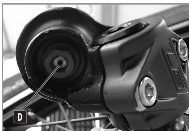
Die Einstellung der Druckstufendämpfung beeinflusst das Verhalten der Gabel beim Einfedern.
