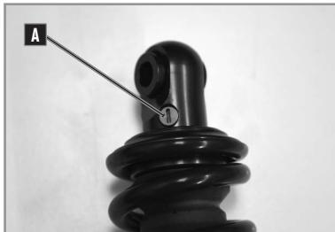
Le réglage en détente de l'amortisseur s'effectue à l'aide de la vis de réglage A située sur la partie supérieure de l'amortisseur.
