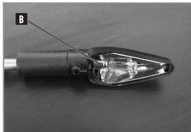
Type d'ampoule: H21W 12V 21W
