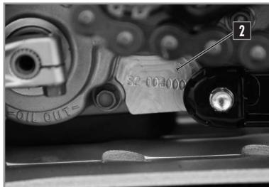
2 Die Identifikationsnummer befindet sich auf der linken Seite des Kurbelgehäuses, neben dem Fußschalthebel.
