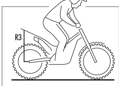
$$R2 - R3 = \text{Hundimiento con carga.}$$
