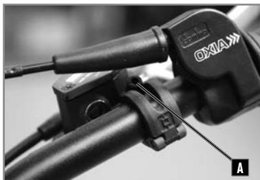
Para poder accionar bien la palanca en el momento de frenar, es necesario que su posición se adapte según cada conductor.
