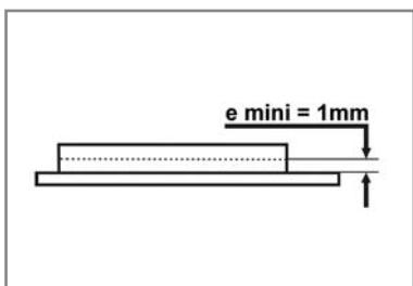
Der Verschleiß der Bremsbeläge tritt im Kontaktbereich zwischen Bremsscheibe und Bremsbelägen auf.
