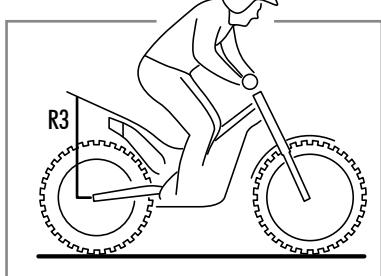
$$R2 - R3 = \text{Hundimiento con carga.}$$
