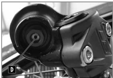
Die Einstellung der Druckstufendämpfung beeinflusst das Verhalten der Gabel beim Einfedern.
