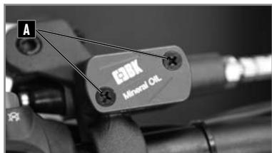
Der Kupplungsflüssigkeitsbehälter befindet sich unter dem Hebel.
