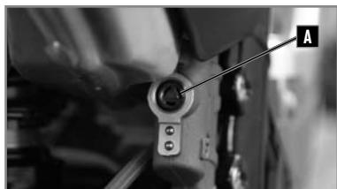
El depósito de líquido de frenos se encuentra directamente en la bomba de freno.
