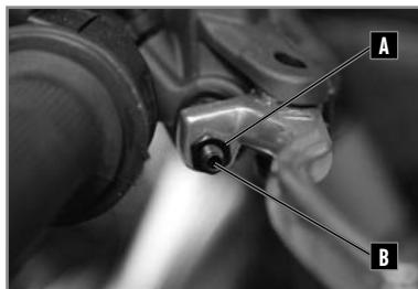
Die Spannung des Vorderradbremshabels wird mithilfe der Gewindestange **B** eingestellt.
