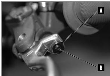
Le réglage de la tension de la manette d'embrayage avant s'effectue à l'aide de la tige filetée **B**.
