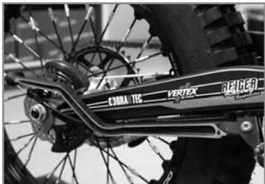
La béquille est située derrière le repose-pied droit. Elle est munie d'un ressort pour en faciliter le pliement.
