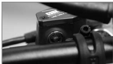
Der Bremsflüssigkeitsbehälter der Vorderradbremse befindet sich neben dem Hebel. Er verfügt über ein kleines Schauglas, mit dem der Flüssigkeitsstand kontrolliert werden kann.
