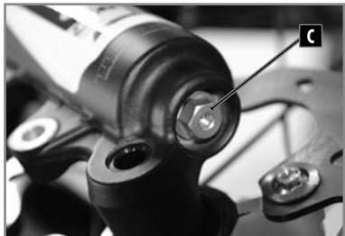
Der Hydrostop-Ring bestimmt das Verhalten der Endlagendämpfung und die Durchschlagfestigkeit der Gabel.
