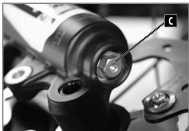
La anilla Hydrostop determina el comportamiento de la amortiguación al final del recorrido y la resistencia de la horquilla a los golpes.
