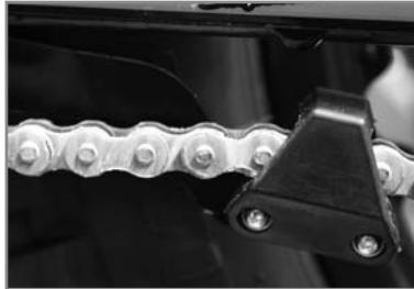
El tensor de la cadena es uno de los elementos que más sufren, especialmente el muelle encargado de mantener la presión sobre la cadena.
