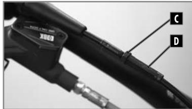
El ajuste también puede realizarse con el tornillo del cable del gas.
