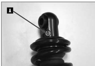
El ajuste de la descompresión del amortiguador debe realizarse con el tornillo de ajuste **A**, situado en la parte superior del amortiguador.
