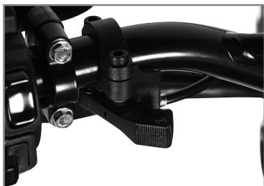
La palanca del starter se encuentra en el lado izquierdo del manillar. Para accionar el starter, presione la palanca.
