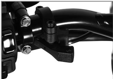
Le levier de starter est positionné sur le côté gauche du guidon. Pour actionner le starter, appuyez sur le levier.
