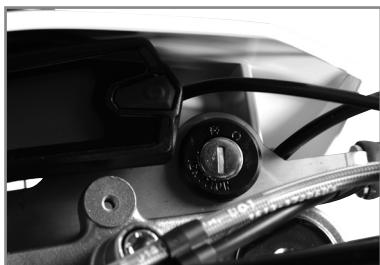
Das Fahrzeug ist mit zwei Schlüsseln ausgestattet (einer als Ersatzschlüssel), zur Betäigung des Schlüsselschalters, um den Motor anzulassen oder auszuschalten.
