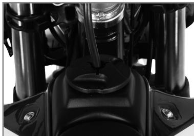
Den Tankverschluss abschrauben, um an den Benzintank zu gelangen.
