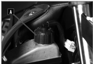
Le contrôle du niveau doit être effectué à moteur froid de la manière suivante :
