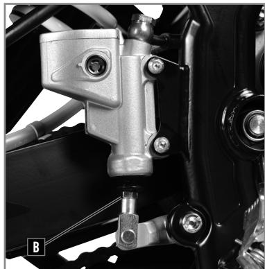
Le frein arrière est à disque à commande hydraulique.
