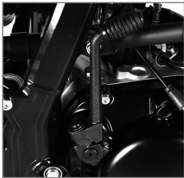
El pedal de arranque se encuentra en el lado izquierdo del motor. La parte superior es rotativa. Para arrancar el motor, saque la palanca hacia fuera y bájela con un golpe seco. La palanca recupera automáticamente su posición original. Después de arrancar, pliegue manualmente la palanca dejándola en posición de descanso.
