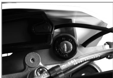
La moto tiene dos llaves (una de repuesto) que permiten encender o apagar el motor.
