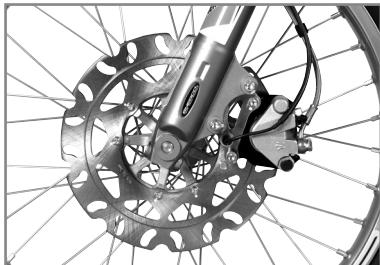
L'état d'usure des plaquettes de frein est visible en regardant l'extrémité des 2 plaquettes sur l'étrier (voir flèche) qui devront avoir au minimum une épaisseur de 2 mm de garniture.
