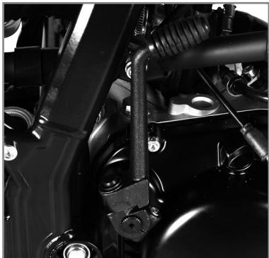
La pédale de démarrage est montée sur le côté droit du moteur. La partie supérieure est rotative. Pour démarrer le moteur, faire tourner le levier vers l'extérieur et donner un coup sec vers le bas. Le levier revient automatiquement vers le haut. Après le démarrage, plier manuellement le levier dans sa position de repos.
