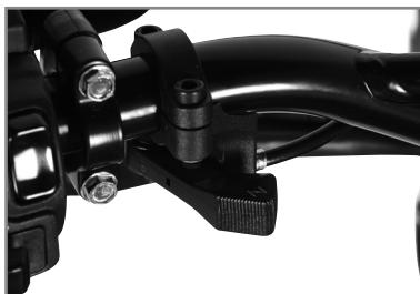
Der Chokehebel befindet sich an der linken Seite des Lenkers. Zur Betätigung des Chokes den Hebel drücken.
